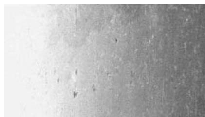
図15 硫酸ナトリウム水溶液による仕上げ面
