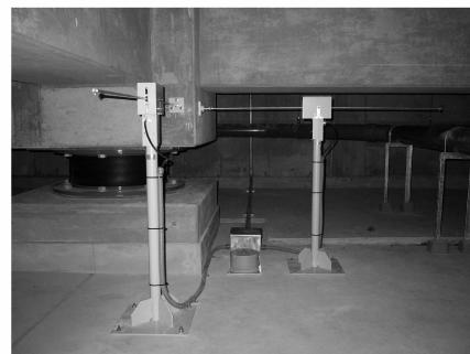
写真2 免震層の変位観測装置と地震計
